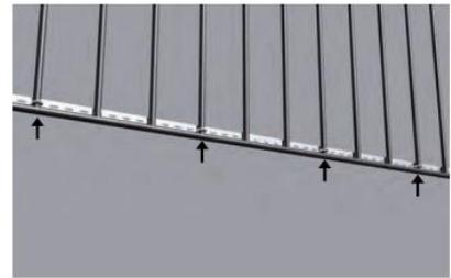
3. Montieren Sie nun bitte, mit gleichem Abstand, die Geländer-Haken an der langen Seite des PV Moduls. Dazu nutzen Sie das Montageset 1. Fädeln Sie auf die Schraube, die Federscheibe und darauf eine Unterlegscheibe. Darauf den Geländer-Haken und darauf erneut eine Unterlegscheibe. Das alles befestigen Sie nun an dem langen Rahmen des Solarmoduls. Achten Sie darauf, dass die Abstände der Geländer-Haken gleich ist und die Geländer-Haken vom Solarmodul nach hinten weg ragt.
