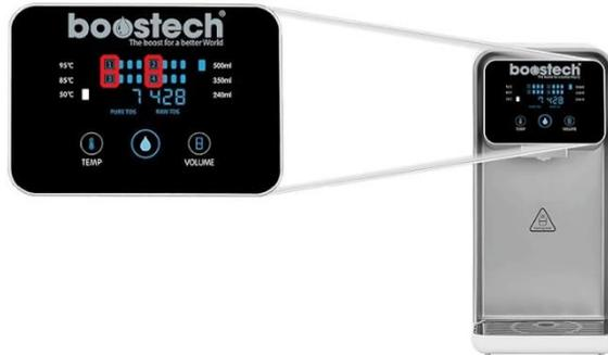
Dieses Display zeigt den Zustand der Filter an. Jede blaue Zahl steht für einen Filter. Wenn alle 3 blauen LEDs hinter einer Zahl aus sind und **blinken**, müssen die Filter gewechselt werden.
